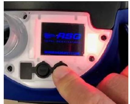
Suivez la sélection de menu en appuyant sur le bouton '+' pour descendre et le bouton '-' pour remonter. Pour sélectionner, appuyez sur le bouton '+' pendant 3 secondes.
