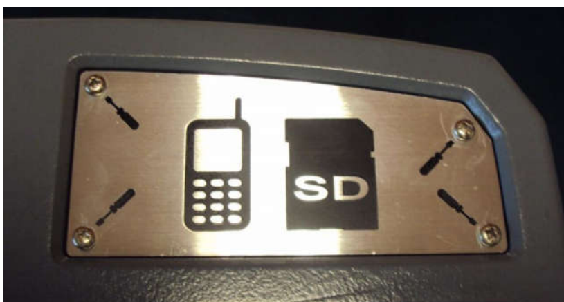
Figure 15 : Plaque de protection de la carte SD
