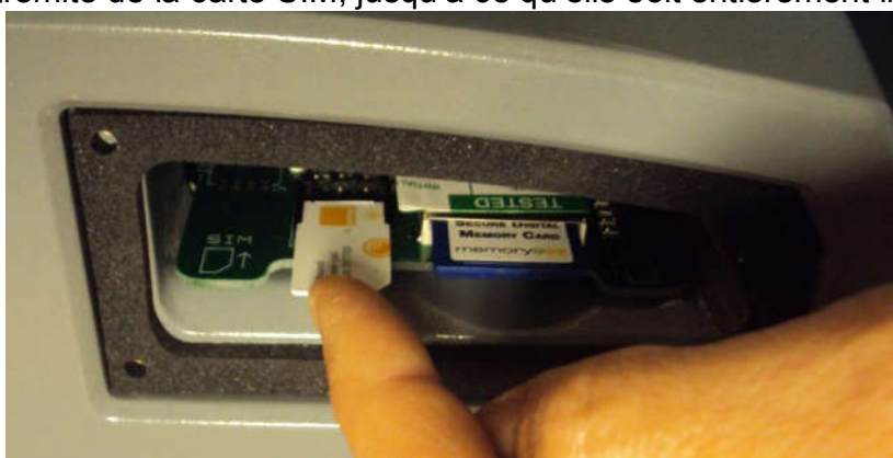
Figure 16 : Insertion de la carte SIM
