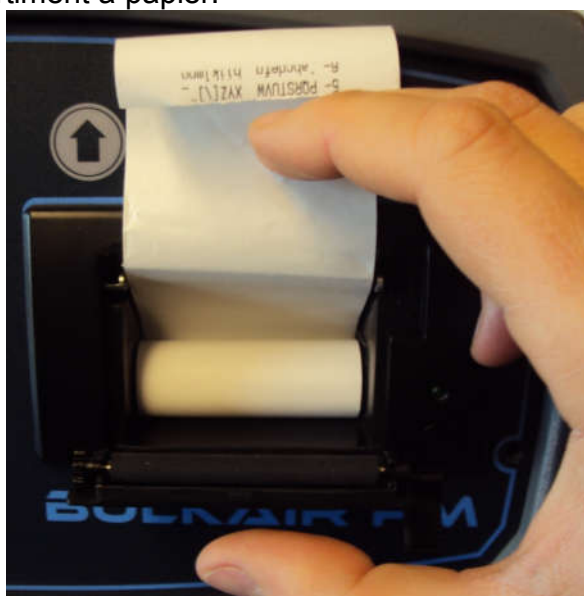
Figure 7 : Insertion d'un rouleau de papier
